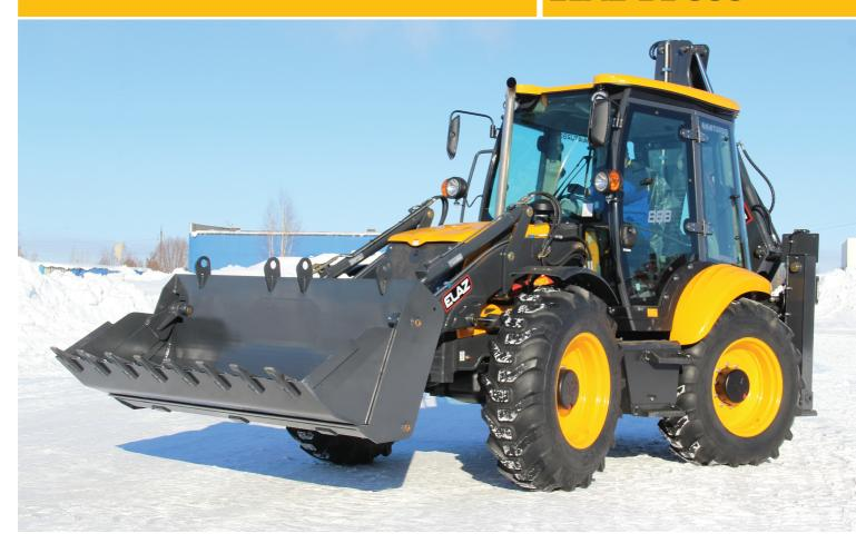
Универсальность экскаватора-погрузчика ELAZ BL повышается за счет возможности использования многочисленного дополнительного оборудования (телескопическая рукоять, гидравлический молот, дополнительные ковши различных размеров, грейфер и др.), применяемое в строительном, дорожно-строительном, коммунальном, горнодобывающем и нефтедобывающем хозяйстве.
