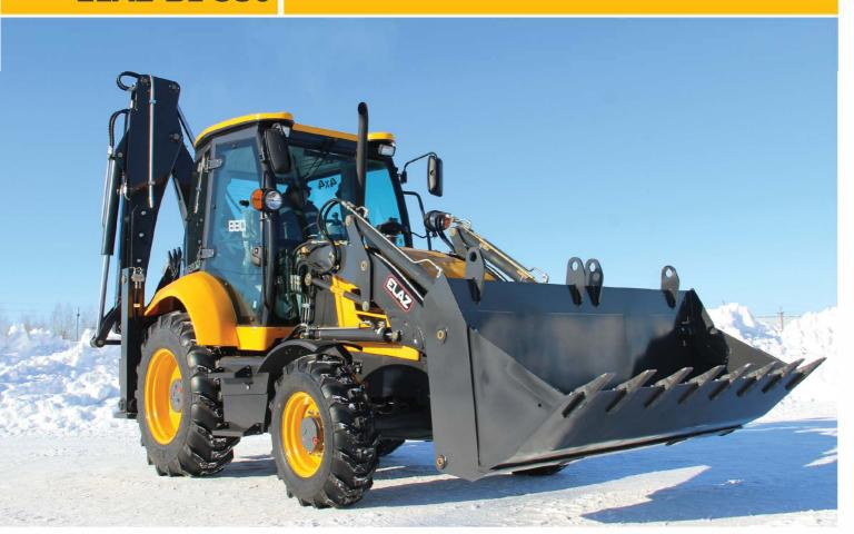
Экскаваторы-погрузчики ELAZ-BL 880 — это универсальная дорожно-строительная техника, которая идеально объединяет в себе функции ковшового экскаватора и фронтального погрузчика. ELAZ-BL 880 относится к машинам нового поколения, в которых реализовано оптимальное распределение благодаря чему обеспечивается безопасное, устойчивое вождение по шоссейным дорогам и твердая основа для копания.
