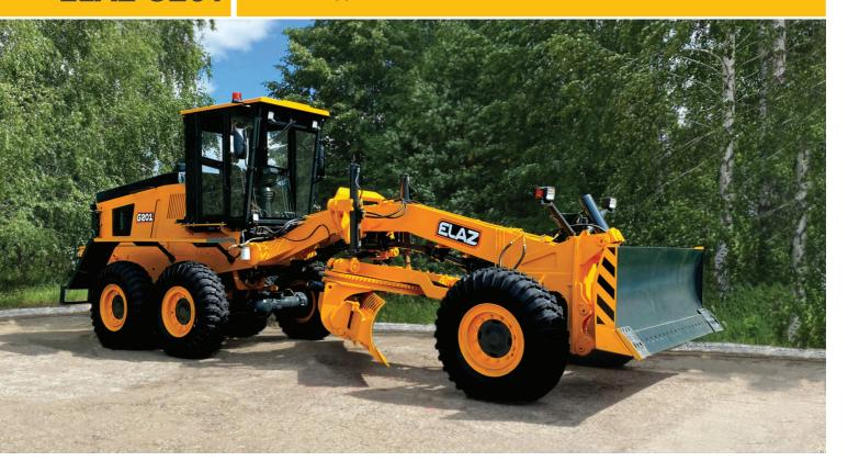
Автогрейдер предназначен для выполнения работ в строительстве, ремонте, содержании дорог и аэродромов. Одним из основных видов выполнения земляных работ является профилирование и планировка поверхности земляного полотна, устройство дренажной системы. Земляные сооружения подобного профиля осуществляются с помощью грейдерного отвала.
