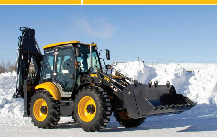
Экскаватор-погрузчик ELAZ-BL 888 универсальная дорожно-строительная техника, которая идеально объединяет в себе функции ковшового экскаватора и фронтального погрузчика.
